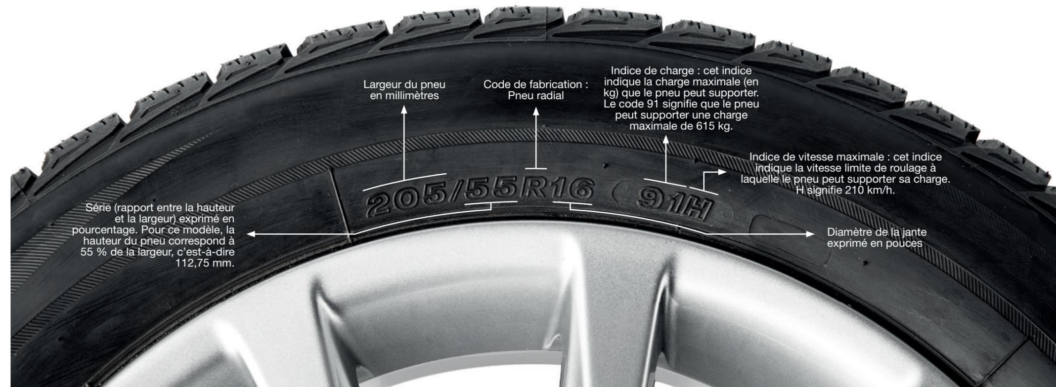
Série (rapport entre la hauteur et la largeur) exprimé en pourcentage. Pour ce modèle, la hauteur du pneu correspond à 55 % de la largeur, c'est-à-dire 112,75 mm.
